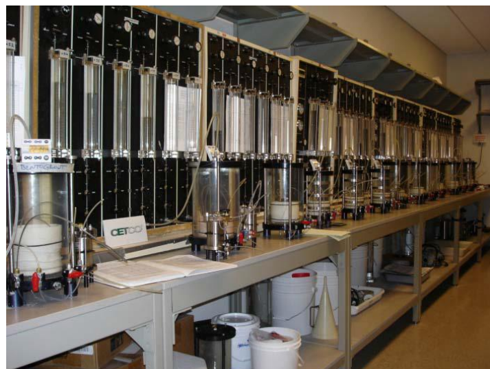
图 8-1 渗透系数测定装置
