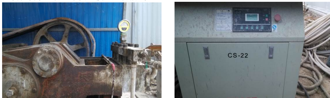
图 15 注浆泵和空压机
